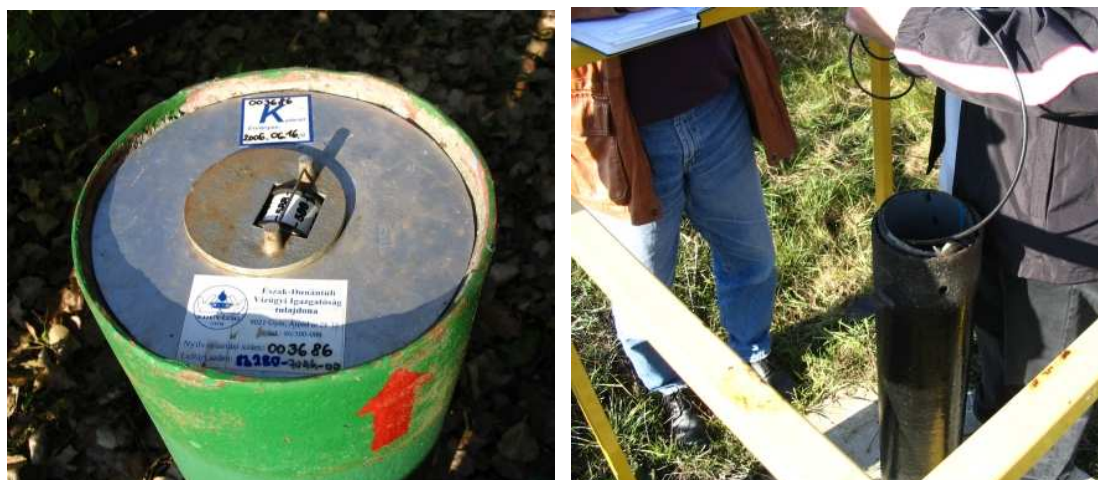
4-4. ábra: Vízszintmérés szondával – egy mechanikus és egy digitális mérőeszköz
